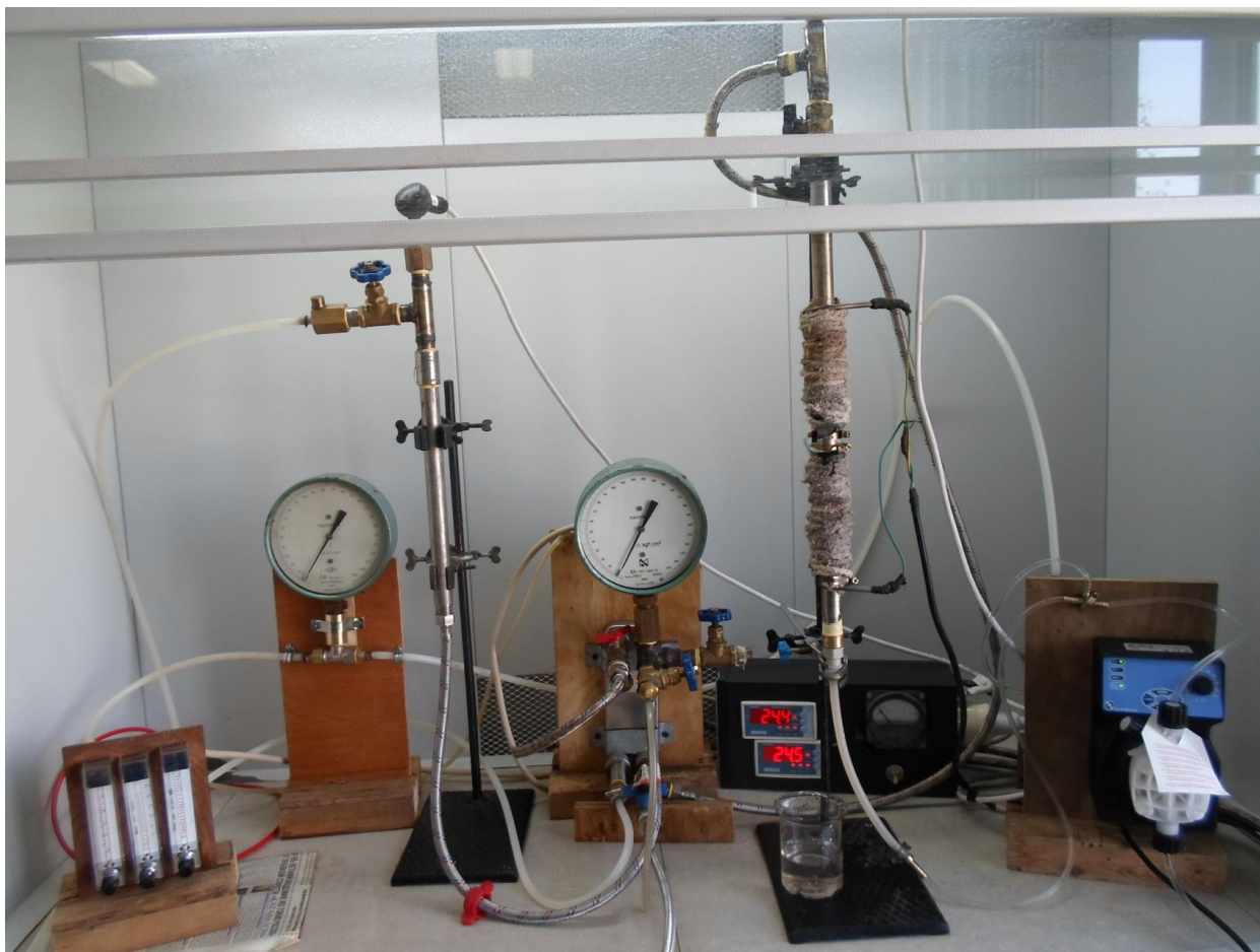
Рисунок – Лабораторная установка 2-х зонного фильтр-реактора для окисления фенолов
